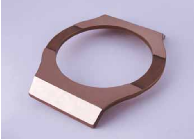
Unzerkratzbares Gold: Forschende der EPFL entwickelten in Zusammenarbeit mit dem Uhrenhersteller Hublot ein Gold, das härter ist als Stahl. Das 18-Karat-Gold ist eine Legierung mit Borcarbid. (Bild: Hublot)
