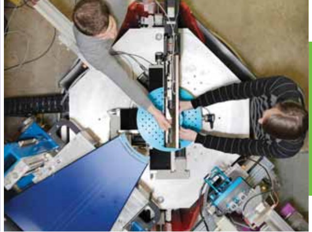
Neutronenuntersuchung von Turbinenschaufeln: Aufgrund der Forschungszusammenarbeit mit dem PSI kann Alstom die Materialermüdung bei Schaufelblättern von Hochleistungsturbinen künftig vermeiden. (Bild: Scanderbeg Sauer Photography)
