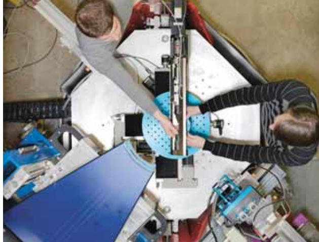
Analyse neutronique des aubes de turbine: grâce à la collaboration de recherche avec le PSI, Alstom pourra éviter la fatigue du matériau dans les aubages des turbines à haute performance. (Photo: Scanderbeg Sauer Photography)
